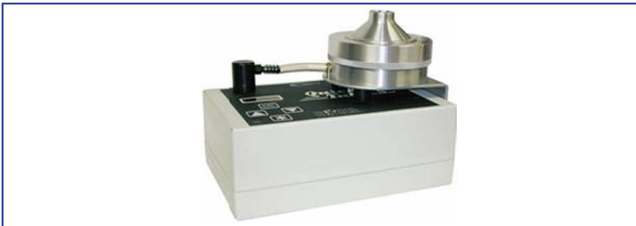
شکل ۲۲- ایمپکتور (Quik Take) مورد استفاده برای نمونه برداری بیوائروسول
